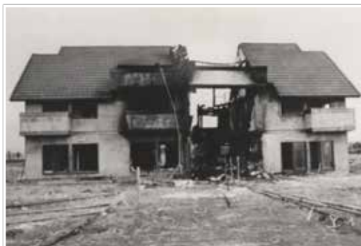
【写真】小屋裏付2階建て枠組木造共同住宅の実大火災実験（舞浜、点火後100分経過の状況、昭和53年12月16日）
