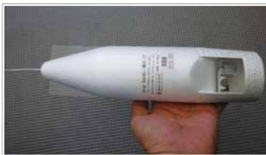
図3 台風の航空機観測で使用するドロップゾンデ(明星電気株式会社製)。右端に温度と湿度センサーが見える。こちら側が下になって落下し、上空から海面までの温度、湿度、気圧、風向・風速、高度を測定する。ボディは生分解性素材でできている。
