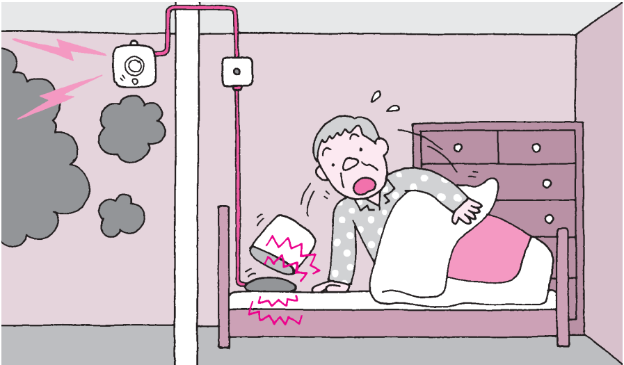
枕を振動させることで火災を知らせている様子
