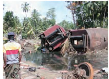
写真1 スリランカ・ヒッカドアで津波によって脱線転覆した列車
