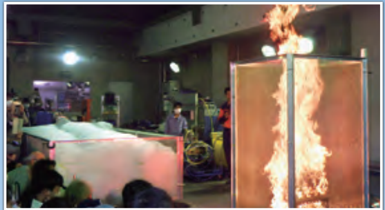
高発砲装置を用いた泡消火実験
